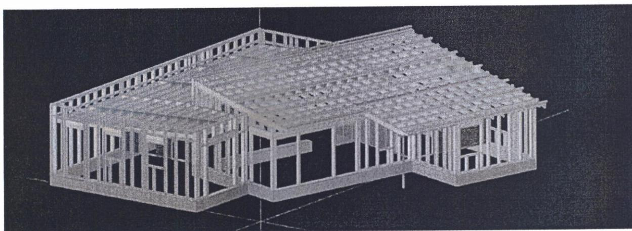
© MADDALON CHARPENTE - La comparaison des modèles numériques respectifs de l'architecte et du charpentier réduit les risques d'erreur entre les fichiers, comme avec ce projet de maison individuelle à ossature bois.
